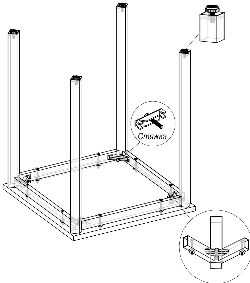
4. Затяните шестигранным ключом до упора все болты, стягивающие опоры с траверсами.
