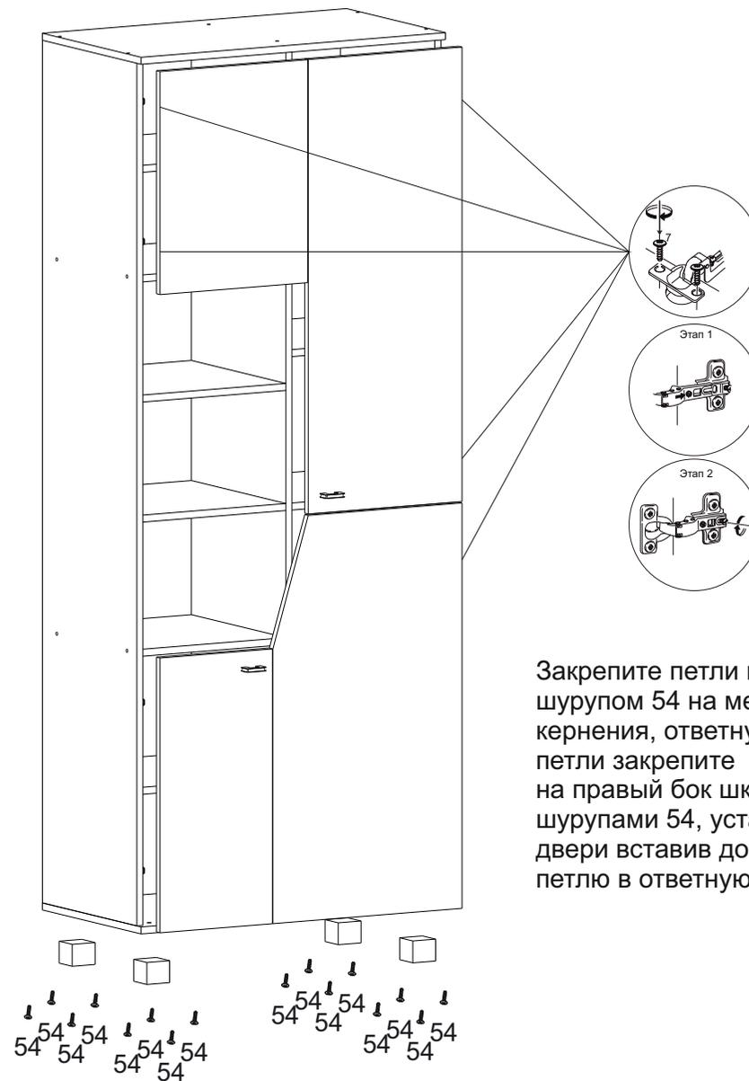
Закрепите петли на двери шурупом 54 на места кернения, ответную планку петли закрепите на правый бок шкафа 3, 4 шурупами 54, установите двери вставив до щелчка петли в ответную планку.
