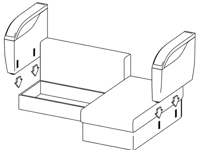
1. Ставим бельевой ящик со спинкой дивана на пол, рядом устанавливаем оттоманку и крепим их друг к другу с помощью одного болта
