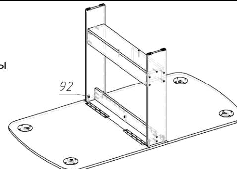
4. Устанавливаем заглушки на евровинты. Устанавливаем опоры следующим образом:
