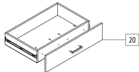
Закрепление накладок ящиков саморезами 3,5x30 осуществлять только после окончательной регулировки накладок.
