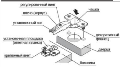
Рис. 2 Установка петель (установка на саморезы 4x16 мм)
