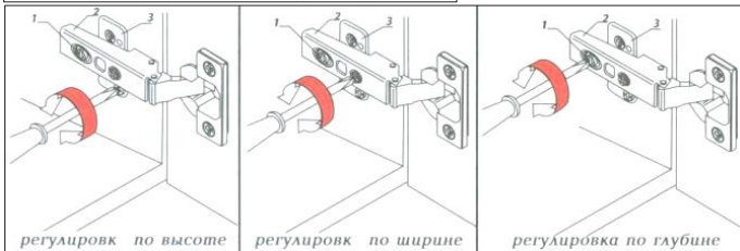
Рис. 3 Регулировка петель
