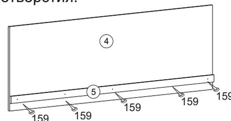
Ребро жёсткости 5 прикрепите задней стенке 4 шурупами 3,5х32 от нижней части задней стенки до нижней части ребра жёсткости должно быть 55 мм.
