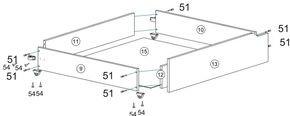
После сборки ящика, на дно закрепите выкатной ролик 118 шурупами 3,5x16 на расстоянии 50 мм. от переднего, и заднего краёв, так чтобы отверстия попадали по центру торца панелей 9,10.
