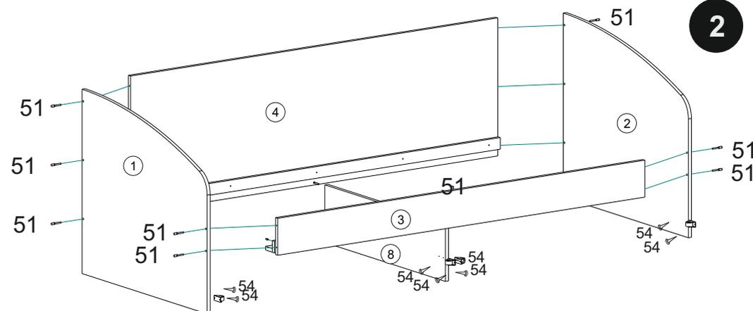
С внутренней стороны изголовья 1, и изножья 2 закрепите выкатной ролик 118 шурупами 3,5х 16 на расстоянии 100 мм. от нижнего края, 23 мм. от переднего края до отверстия.
