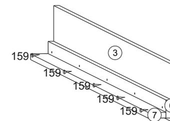
Ребро жёсткости 6 прикрепите передней стенке 3 шурупами 3,5х32 от нижней части передней стенки до нижней части ребра жёсткости должно быть 10 мм.
